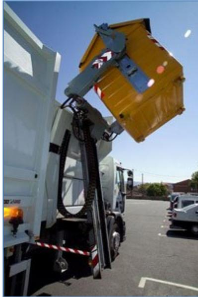
1ª Fase: Descenso de las barras de seguridad “ENPI”. Estas barras garantizan la realización de las maniobras de carga y descarga con total seguridad. Si el descenso de estas barras no es tal, debido a la existencia de algún obstáculo, las operaciones de carga y descarga se bloquean automáticamente.
